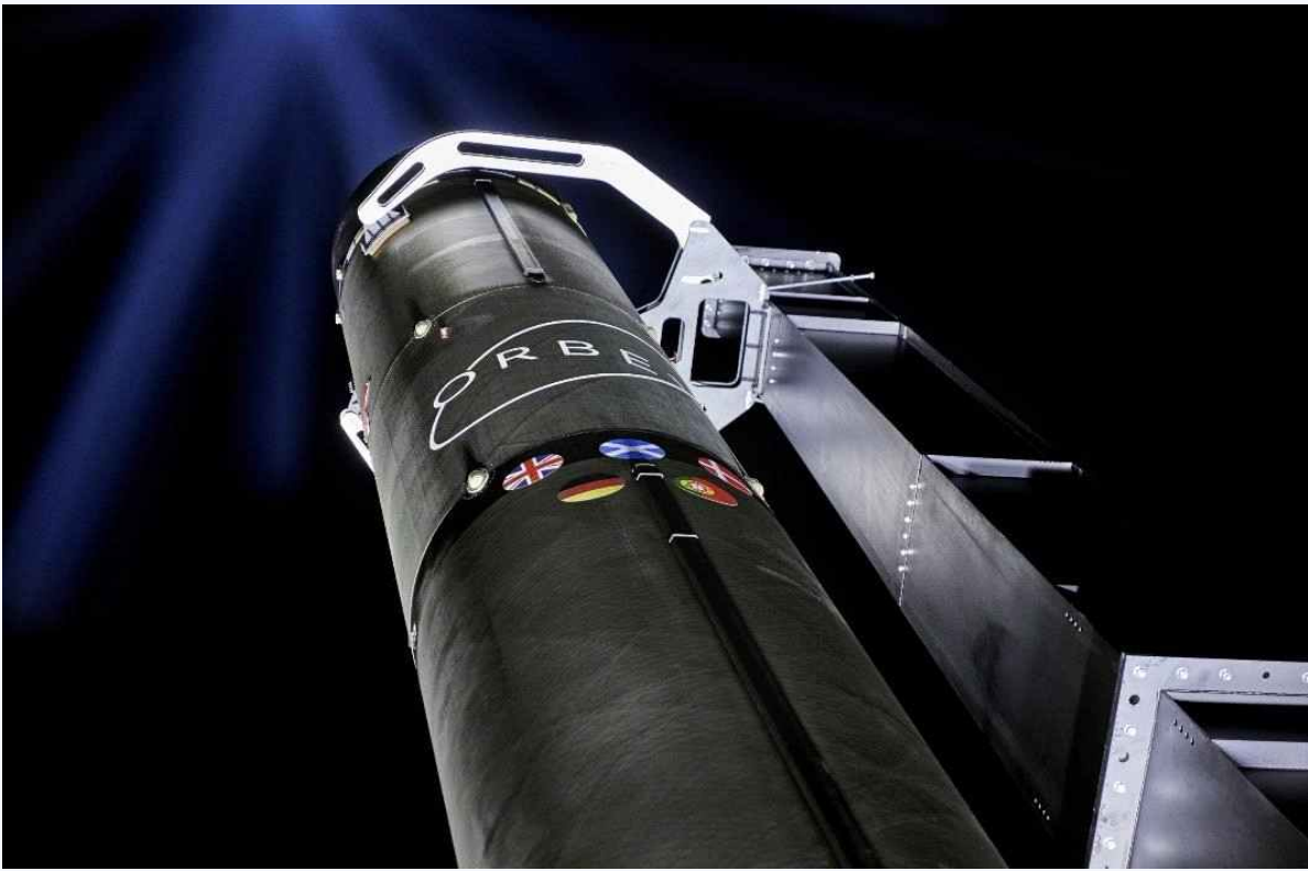
< 그림 63 > 180kg 위성을 최대 780 mi의 고도까지 끌어 올릴 수 있는 올백스 프라임107)
