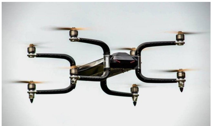
그림37. 고중량 짐 운반에 최적화 된 Griff Aviation 의 드론
