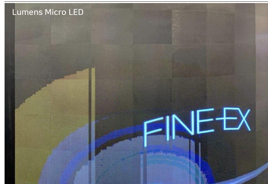
그림56. 루멘스 Micro LED의 Module간 단면 불량
