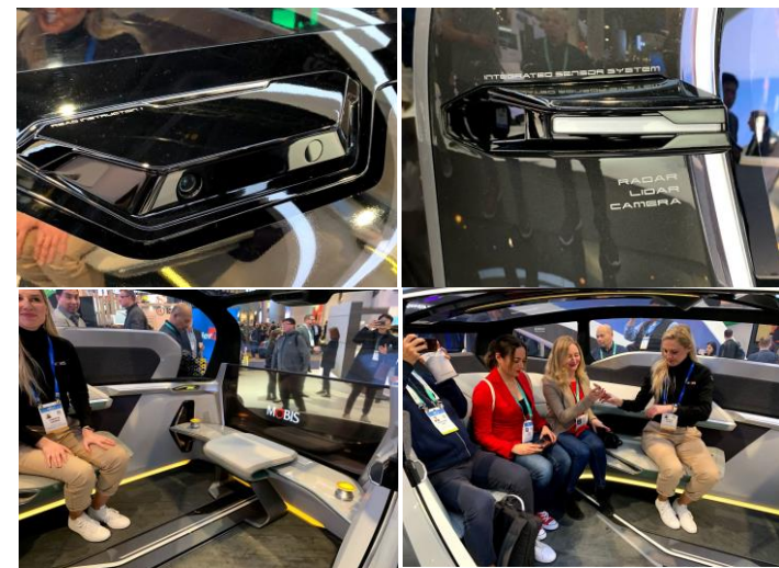
그림128. M.Vision의 통합형 센서시스템과 가변형 시트시스템
