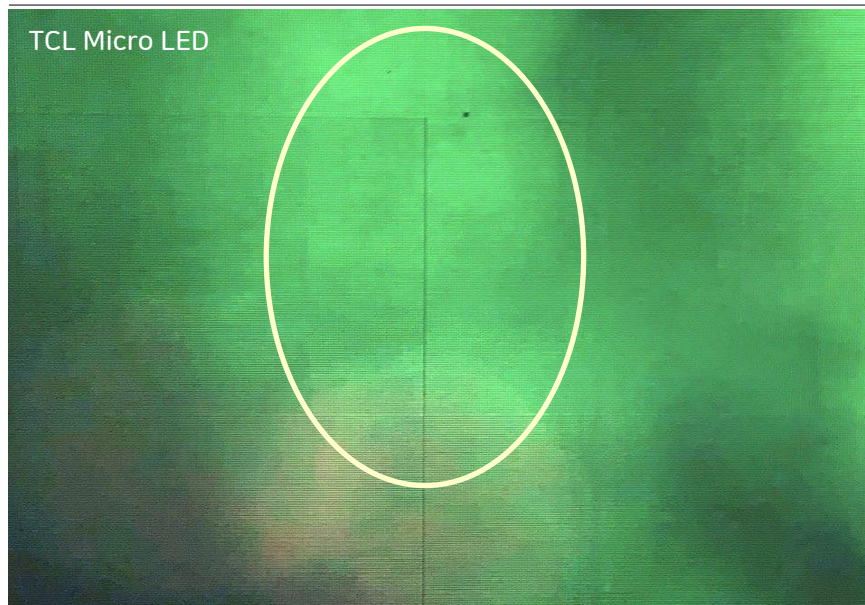
그림55. TCL Micro LED의 Module간 단면 불량
